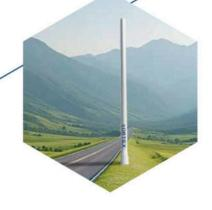
此外,无叶片风力发电机的维护成本也降低了,因为它不需要重新校准或添加润滑油的齿轮或制动器。在设备疲劳方面,它使用的碳纤维寿命可达数十年。由于沃振无叶片风机重量很轻,重心更靠近地面,与传统涡轮机相比,锚定或地基要求大大降低,从而简化了安装。
