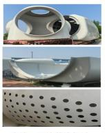
**壳体、罩体裁边打孔** 机舱罩、导流罩、风 机罩等壳体结构的裁 边、打孔
