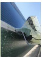
**叶片飞边一次性裁切** 叶片压制后飞边的自 动化、免打磨裁切
