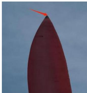
无人机拍摄的#10风机，叶片#3图像，经检查叶片顶端出现缺口，存在雷击痕迹。
