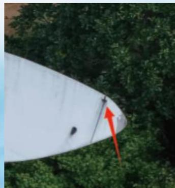
无人机拍摄的#27风机，叶片#3图像，叶片上存在雷击点。
