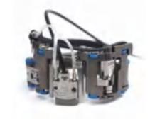
小管径焊缝扫查器 R20 系列
