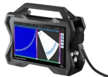
Phaseye FMC-64 超声波相控阵探伤仪
