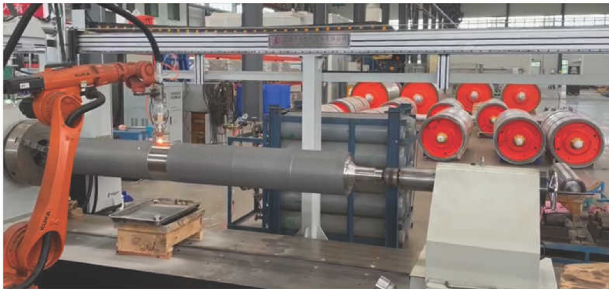
6kw轴类激光高速熔覆实例
