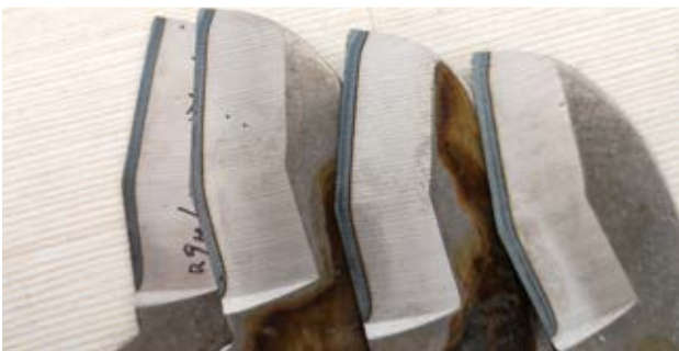
割管刀刃口激光淬火
