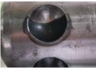
球头凹面矩形光斑激光淬火
