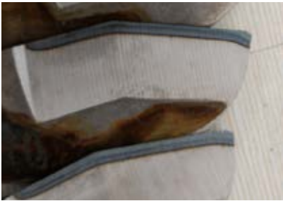
割管刀刃口激光淬火
