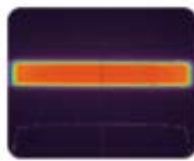
积分光斑预览图 光斑大小可变，可生成各种几何形状
