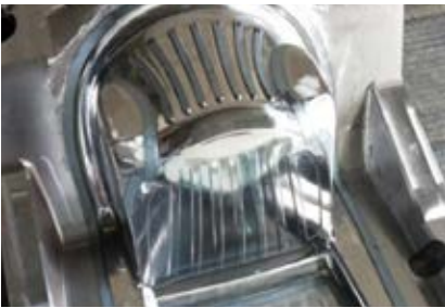
汽车座椅模具激光淬火
