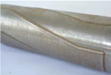
常规激光熔覆：起伏大
