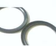
VG、VB型油封是在無壓力狀態下使用的, 多用於防塵密封和外界無塵的潤滑脂密封, 所用軸轉速較高。
