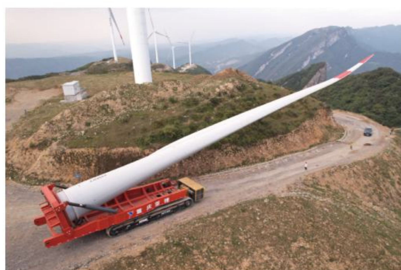
丰都五洞岩叶片全履带车运输
