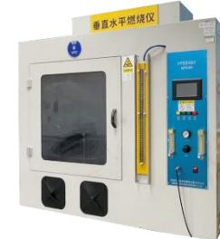
水平垂直燃烧试验仪
