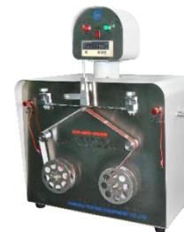
汽车电线耐砂磨试验机
