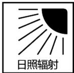
**日照辐射:** EN 60068-2-5 (2011)。在环境温度为55° C、辐射强度为1120 W/m<sup>2</sup>的条件下进行24小时的紫外线辐射测试。
