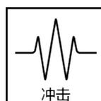
**机械冲击测试Ea和CAF2656:** EN 60068-2-27 (2009)。尖峰加速：50G。时长：11ms。脉冲波形：半正弦波。
