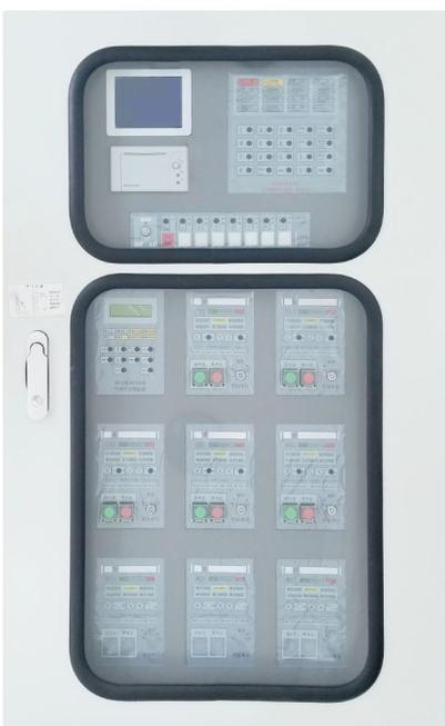
控制器可带2条总线回路, 每条回路可接64只总线负载, 共128只负载。探测器、手动报警按钮、输入模块、输入输出模块可以混合编址。
