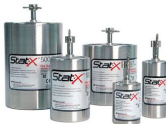
气溶胶灭火装置在接到启动信号后,电引发器或热引发器启动时引爆气溶胶药剂燃烧,当气溶胶药剂燃烧时形成分散的气体生成物,其穿过冷却剂流向多喷管格栅网眼喷向防护空间,从内部抑制燃烧。
