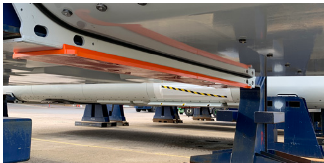
内嵌磁铁的聚氨酯垫，可在运输过程中保护机舱。
