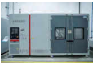
Water Pressure Pulse Test 水脉冲试验
