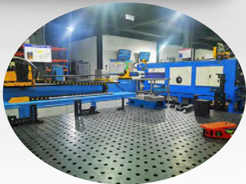
弯管机及操作平台
