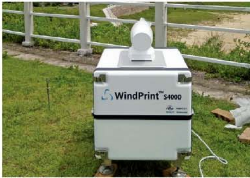
沿海某风电场风功率预测系统
