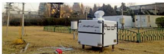
WindPrint S4000与中科院大气物理所325m铁塔对比测试
