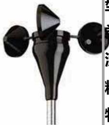
型号：Class1 Anemometer
