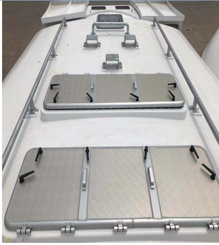
中车 机舱罩吊装舱盖
