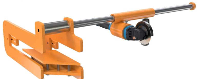
开槽工具通过在偏航制动盘上切割凹槽来降低偏航制动噪音,当机舱迎风移动时,槽口就像一把剃刀,可以去除制动片上的碎屑。
