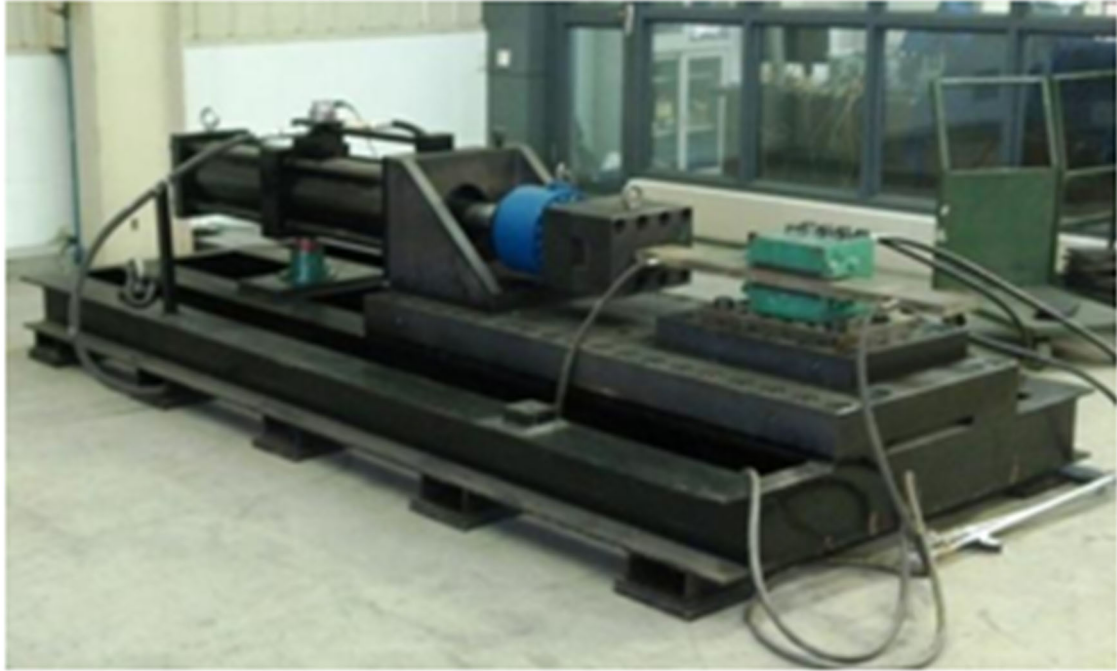
美国穆格风力发电机偏航制动卡钳疲劳耐久测试系统
