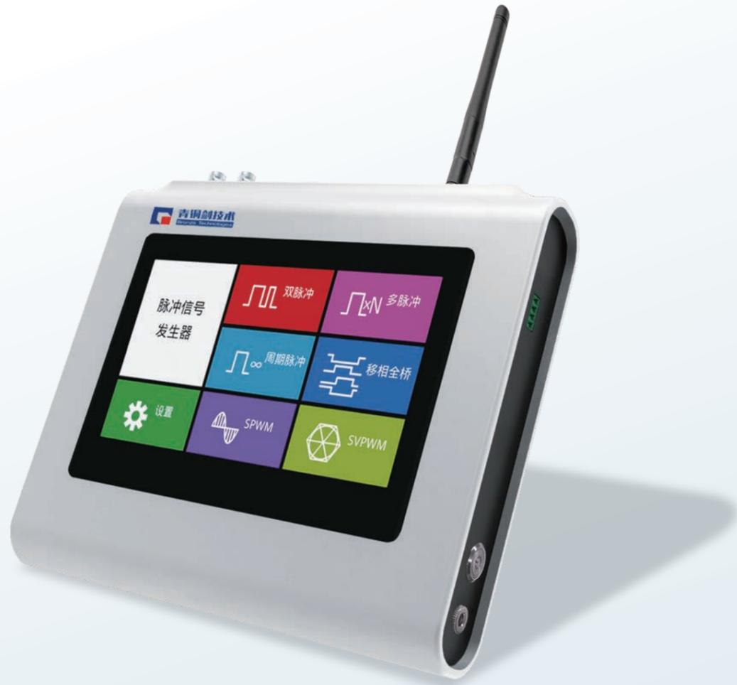
QTJ15610A 是一款针对功率半导体器件动态特性测试而开发的辅助发波设备，能输出包括单脉冲、双脉冲、多脉冲、SPWM、SVPWM 和移相全桥在内的多种驱动信号。为满足客户不同的应用场景，QTJ15610A 兼容工业输出端口、BNC 端子、简易牛角连接器、光纤端口等连接方式。并且，为避免高电压、大电流测试带来的人身安全风险，QTJ15610A 集成无线通讯功能，可利用手机、PC、平板电脑等智能终端设备进行远程操作。
