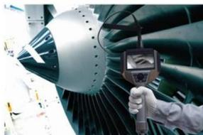
飞机发动机的燃烧室、叶片、涡轮等内部隐患的检测，及其他焊缝表面、管路内部定期检测与维护等；
