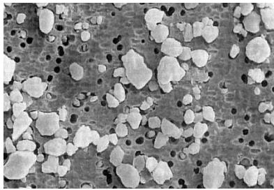
实现了对 40um 铁颗粒 (Fe) 和 150um 非铁颗粒 (NFe) 的检测能力。
