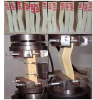
MTS拉扭材料试验系统 新型竹制材料复合材料测试
