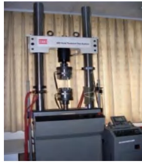
MTS拉扭材料试验系统 新型竹制材料复合材料测试
