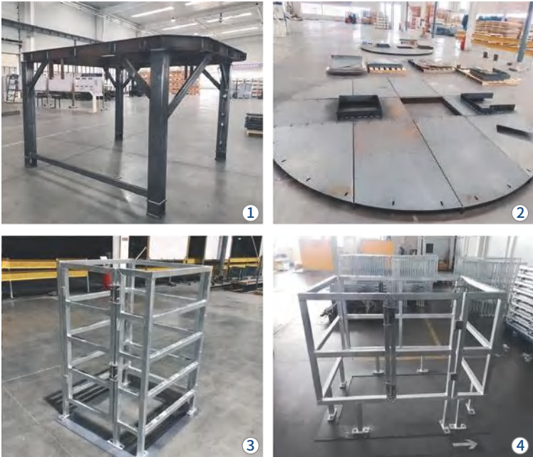
① 电器平台框架 ② 平台面板（黑） ③ 电缆铁护栏 ④ 铝方形护栏
